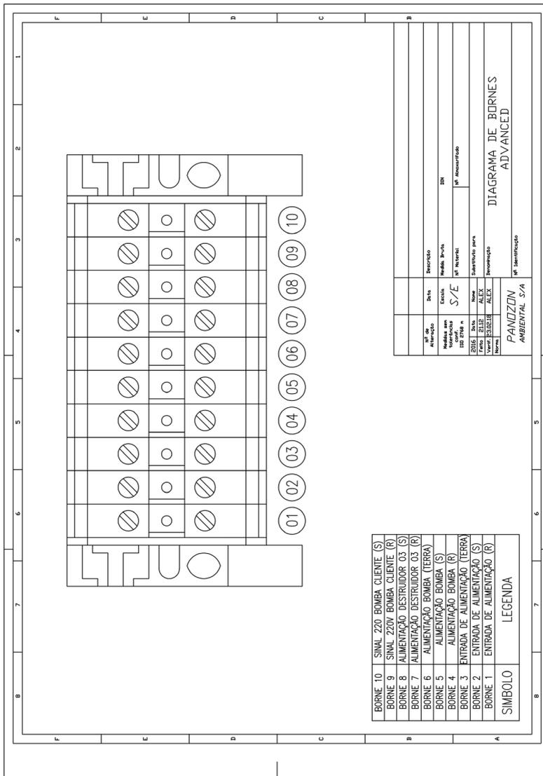
**Observação:** O 220V da bomba do cliente deve ser conectado em paralelo com os bornes 09 e 10 para que o acionamento do Panozon Advanced seja automático junto com o acionamento da bomba.
